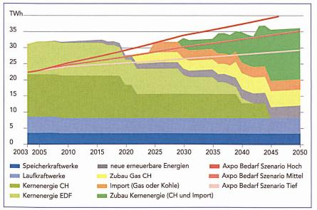
Bild 5 Möglicher neuer Strommix von Axpo.
