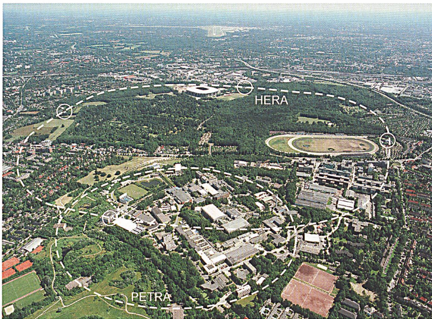
Die Hadron-Elektron-Ring-Anlage HERA ist der grösste Teilchenbeschleuniger beim Deutschen Elektronen-Synchrotron DESY in Hamburg. Die Anlage ist seit 1992 im Forschungsbetrieb. HERA ist der erste und einzige Speicherring, bei dem beide Arten von Materieteilchen miteinander kollidieren: Protonen und Elektronen (bzw. ihre Antiteilchen, die Positronen). HERA besteht aus zwei ringförmigen, jeweils 6,3 Kilometer langen Beschleunigern in einem unterirdischen Tunnel.
