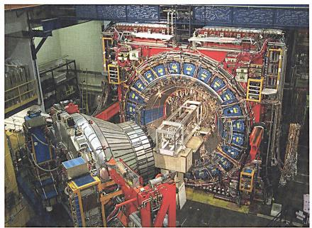
Der «Collider Detector» im Fermilab (CDF) soll Erkenntnisse über das Zusammenprallen von Hochenergiepartikeln im stärkstem Teilchenbeschleuniger der Welt bringen (Bild Fermilab; Batavia Illinois/USA).
