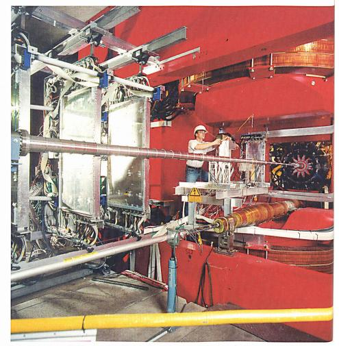
In der 6,3 km langen Speicherringanlage HERA (Hadron-Elektron-Ring-Anlage) werden Protonen und Elektronen beschleunigt. Das Experiment HERA-B nutzte ausschliesslich den Protonenstrahl, um die Physik der «schweren Quarks» zu untersuchen. Das Bild zeigt den HERA-B-Detektor im Aufbau (Bild: DESY Hamburg).
