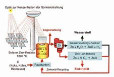
Prinzipschema der solaren Zinkgewinnung; dabei dient Zink als Speichermaterial, das im Kreislauf geführt wird.
