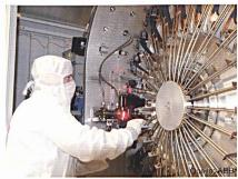
Mit diesem Gerät werden Fremdatome in die Wafer implantiert – im Betrieb ist es natürlich geschlossen und die Wafer werden automatisch auf dem «Karussell» platziert.
