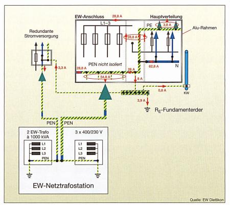
Bild 3 Gebäudestromversorgung und Stromversorgung für Sicherheitszwecke gemäss VKF-Brandschutzrichtlinie, Einspeisungen im TN-C-System. Magnetische Flussdichte 18 μT im Abstand von 20 cm um den Alu-Rahmen der Hauptverteilung.
