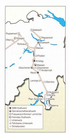
Bild 2 Auszug der Übertragungsleitungen aus dem SBB-Netz im Raume Rupperswil/Seebach–Uri–Tessin Die Leitungen mit 132 kV sind rot, die Leitungen mit 66 kV schwarz dargestellt.
