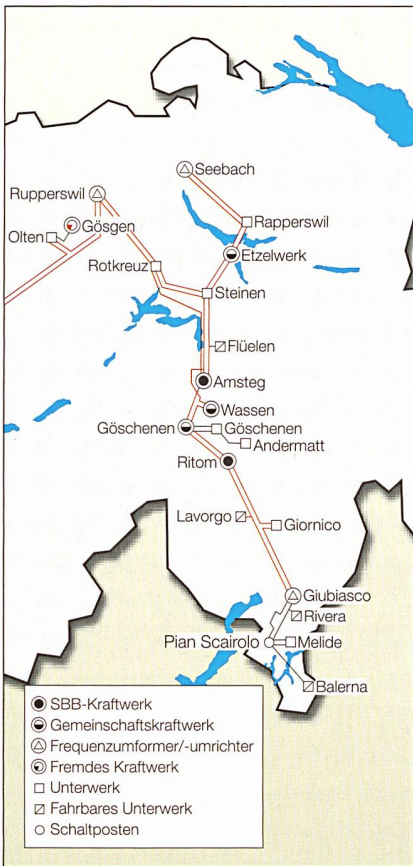
Bild 2 Auszug der Übertragungsleitungen aus dem SBB-Netz im Raume Rapperswil/Seebach-Uri-Tessin. Die Leitungen mit 132 kV sind rot, die Leitungen mit 66 kV schwarz dargestellt.
