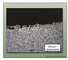
Bild 4 Gefüge von Ag/SnO<sub>2</sub> 12<sup>3)</sup>, hergestellt nach dem Reaktionssprühverfahren mit den Zusätzen Bi<sub>2</sub>O<sub>3</sub> und CuO, im oberen Bereich durch Schaltlichtbögen beeinflusst
