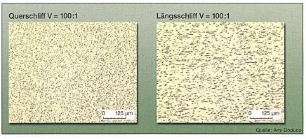
Bild 2 Gefüge von Ag/Ni 103)
