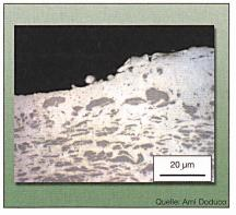
Bild 1 Ag/Ni-20<sup>3)</sup>-Gefüge nach Lichtbogenbeanspruchung
