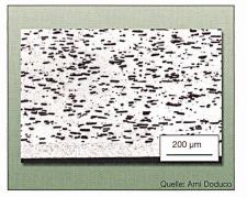
Bild 7 Längsschliff-Gefüge von Ag/C mit Anteil an Grafitfasern, an der Unterseite Schweissrücken aus Ag/Ni 10<sup>3)</sup>
