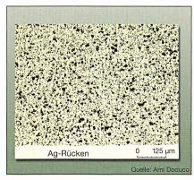
Bild 5 Gefüge von Ag/SnO<sub>2</sub> 12<sup>3)</sup>, hergestellt nach dem Reaktionssprühverfahren mit Schliff senkrecht zur Strangpressrichtung
