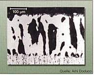
Bild 6 Schaltgefüge von Ag/C 3<sup>3)</sup> nach Lichtbogeneinwirkung
