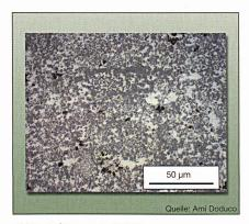
Bild 8 Gefüge von Ag/W 503)
