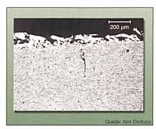
Bild 3 Zerklüftete und SnO<sub>2</sub>-verarmte Kontaktoberfläche von Ag/SnO<sub>2</sub> (gesintert und stranggepresst, mit MoO<sub>3</sub>-Zusatz) nach Beanspruchung durch Einschaltlichtbögen
