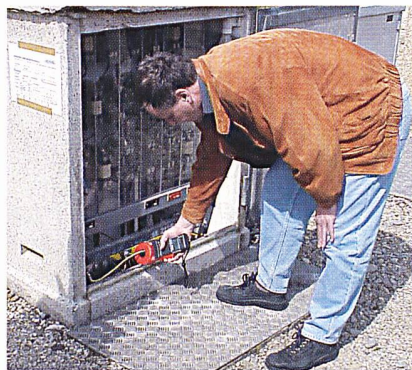
Erdungsmessung in Verteilkasten.
