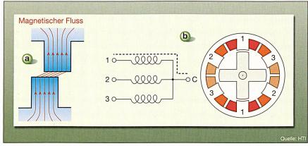
Bild 1 a) Reluktanzprinzip; b) Reluktanz-Schrittmotor mit Wicklungsschema
