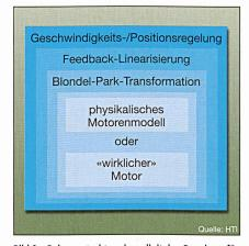
Bild 9 Rahmenstruktur einer digitalen Regelung für einen Wechselstrommotor
