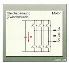
Bild 4 Wechselrichter mit antiparallelen Freilaufdioden
