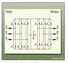
Bild 5 Wechselrichter mit bidirektionaler Speisung
