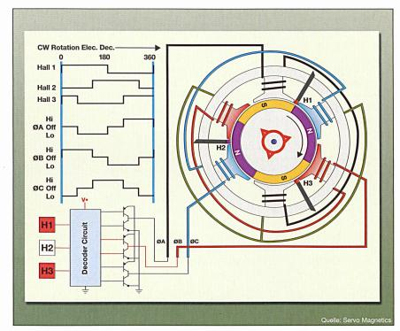
Bild 3 Schema und Funktionsweise des Brushless-DC-Motors
