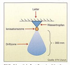
Bild 3 Schematische Darstellung einer Störstelle (hier: Wassertropfen) im elektrischen Feld Unterscheidung der Ionisationszone und der Drift-
