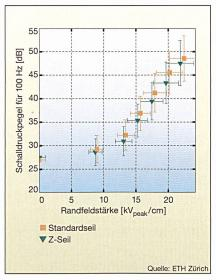
Bild 8 Lärmemission im 100-Hz-Terzband für je ein «kurzes» Z- und ein Standardseil
