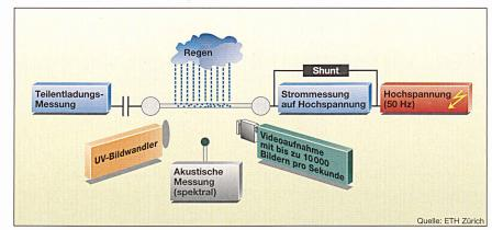
Bild 2 Aufbau des zentralen Laborexperiments mit beregneten Leiterseilen oder Modellleitern
