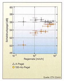
Bild 6 Schallemission im 100-Hz-Terzband und A-Pegel für einen «langen» Aluminium-Modellleiter
