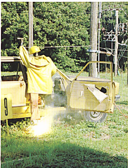
Tödliche Folgen: Auf das Auto ist das Kabel einer Freileitung gefallen.
