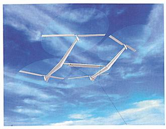
Illustration des fliegenden elektrischen Windkraftwerks (Leistung 1,5 MW/Bild Sky WindPower).
