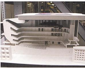
Gipsmodell des Konzertsaals im Querschnitt. 24000 der Gipskachel-Modelle links und rechts im Bild ergeben im eigentlichen Saal das Wandrelief. Ihre wabenförmige Struktur vergrössert die Wandoberfläche und erlaubt eine optimale Streuung des Klangs.
