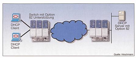
Bild 3 «Plug-and-Work» – Automatische Inbetriebnahme mit der DHCP-Option 82
