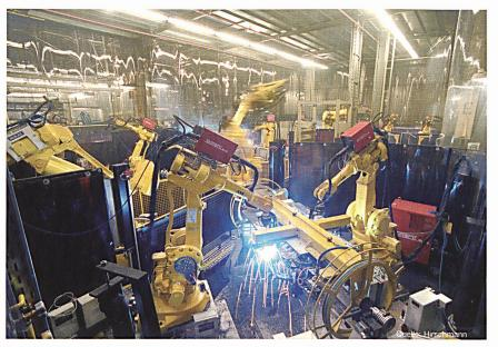
Bild 1 Die Roboter werden über Ethernet gesteuert – über dasselbe TCP/IP-Protokoll, wie es der Büro-PC
