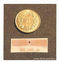
Bild 10 Microwave-Transponder mit Chip und Dipol-Antenne, Lesedistanz >1 m
