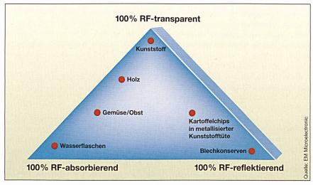
Bild 11 Reflexionen und dämpfendes Material stören die Funkübertragung.
