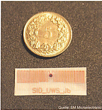
Bild 10 Microwave-Transponder mit Chip und Dipol-Antenne, Lesedistanz >1m
