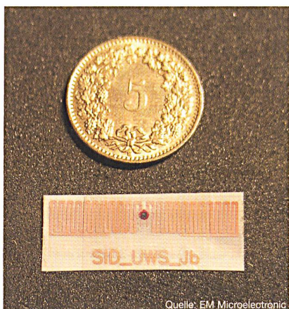
Bild 10 Microwave-Transponder mit Chip und Dipol-Antenne, Lesedistanz >1m
