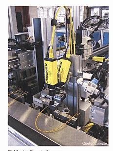
Bild 6 Intelligente Kameras Smart Cameras verfügen über lokale Intelligenz. Visualisierung, Erfassung der Produktionsdaten und Parametrierung erfolgen über Ethernet.
