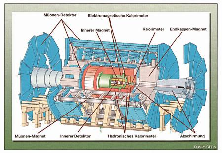
Bild 3 Der ATLAS-Detektor am CERN
