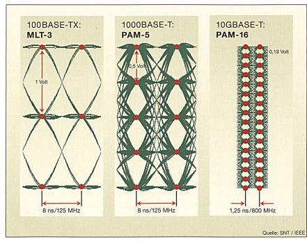
Bild 3 Ethernet-Kodierungsverfahren in der Übersicht (Zeitachse nicht massstäblich)
