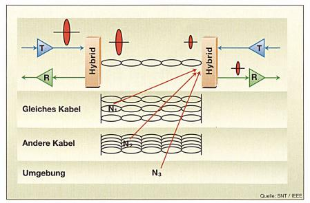
Bild 4 Signal und Störungen bei 10GBase-T
