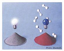
L'alliage métallique LaMg<sub>2</sub>Ni (à gauche) est un conducteur électrique. En présence d'hydrogène (les «haltères» blancs), il forme l'hydrure métallique LaMg<sub>2</sub>NiH<sub>7</sub> (à droite) qui lui est un isolant. Cette propriété pourrait en faire un détecteur d'hydrogène efficace et bon marché.
