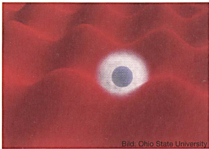
Einzelne Atome sollen in Senken festgehalten und ihre Quanteneigenschaften durch Laserlicht ausgelesen werden.
