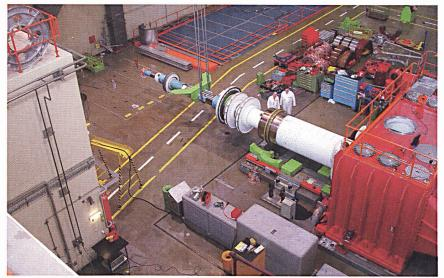
Der Rotor wird ausgefahren (Bilder: kkl).
