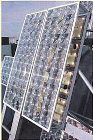
Flatcon-Konzentratormodul (Bilder Fraunhofer ISE).
