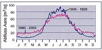
Bild 5 Die blaue Kurve zeigt das natürliche Abflussregime der Aare bei Brienzwiler von 1905 bis 1928 (vor Bau der Stauseen) und die rote Kurve den Abfluss von heute (1980 bis 2003). Die Speicherseen der KWO (Bild 1) halten im Sommer die Differenz zwischen blauer und roter Kurve zurück und geben dieses Wasser während den Wintermonaten wieder ab.
