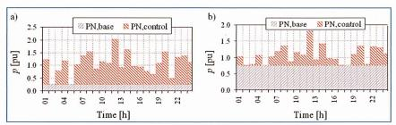
Bild 7 Grundlast und vom Nachbarsystem eingespeiste gesteuerte Last ohne (a) und mit WAMS-basiertem Rundsteuerungssystem (b).
