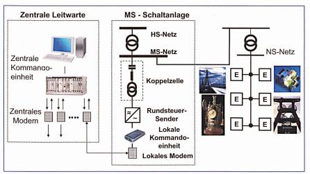
Bild 1 Rundsteuerung - traditionelle Konfiguration.
