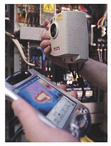
Infrarotkamera IR1011 von Transmetra Haltec im Einsatz
