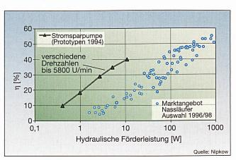
Bild 4 Wirkungsgrad von Umwälzpumpen [4]
