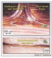
Bild 4 Electrical trees in einer Isolierung
