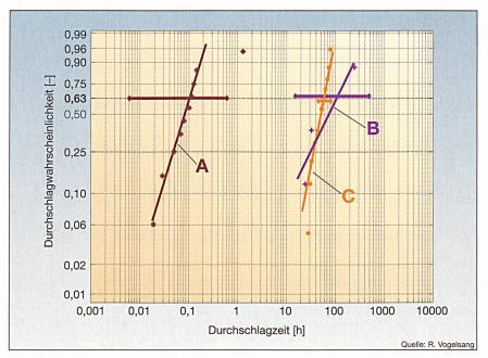
Bild 6 Durchschlagzeiten von VPI-Isolierungen unterschiedlicher Firmen
