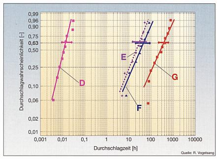
Bild 8 Durchschlagzeiten von RR-Isolierungen unterschiedlicher Firmen
