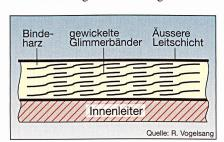
Bild 1 Struktur einer Wicklungsisolierung Halbüberlappende Glimmerbänder
