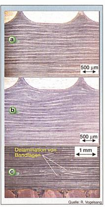
Bild 5 VPI-Wicklungsisolierung
