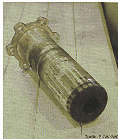
Bild 2 Schaltkontakt eines \text{SF}_6 -Schalters
