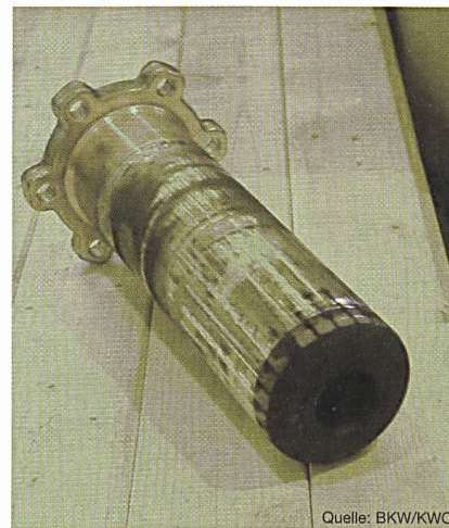
Bild 2 Schaltkontakt eines SF 6 -Schalters Abbrandspuren am Schaltkontakt eines 220-kV-SF 6 -Schalters
