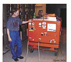
**Bild 4 Gas-Aufbereitungsanlage**DILO-Gasaufbereitungsanlagen Typ MEGA, Saugvermögen: 30 m³/h; Vakuumpumpe: 65 m³/h
