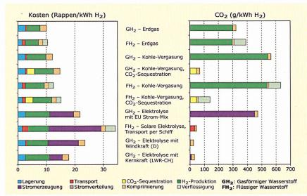
Je grüner der Wasserstoff, umso teurer wird er: Kosten und CO<sub>2</sub>-Emissionen von Wasserstoff je nach Energiequelle (Wietschel und Hasenauer, 2004; Erweiterung durch PSI, 2004).
