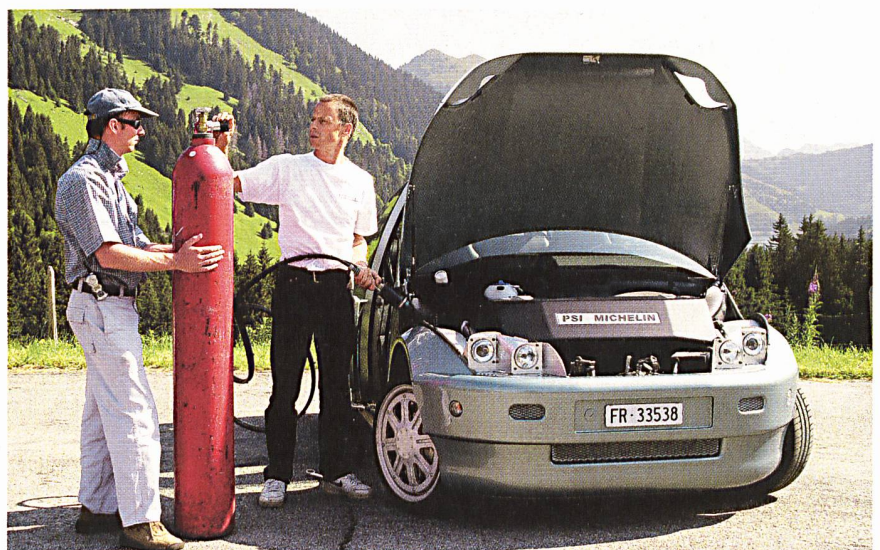
Tanken von Wasserstoff: Mit einer Tankfüllung kann der HY-LIGHT 400 km fahren, eine Spitzenreichweite für ein Brennstoffzellen-Auto.
