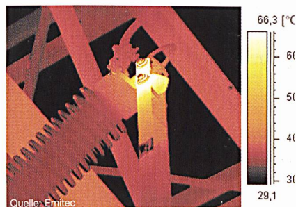
Infrarotbild einer heissen Anschlussklemme. Korrosion führte zum schlechten Kontakt.
