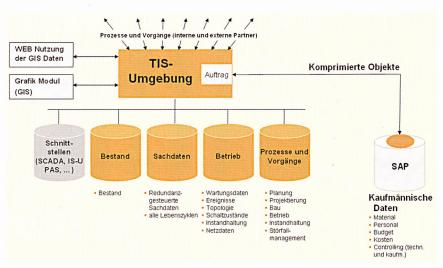
Bild 1 Aufbau eines integrierten TIS mit Anbindung an SAP. Orange sind die Bereiche, die TOMS abdeckt.
