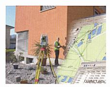
Einmannstation mit Vermessungssoftware Mobilematrix via Funk am Reflektor
