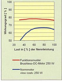
Wirkungsgrade des neuen Brushless-DC-Motors und eines Normmotors
