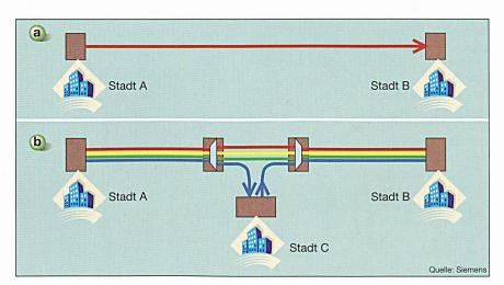
Bild 1 Auskoppeln von optischen Kanälen
