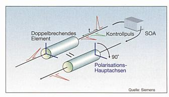
Bild 5 Schematische Anordnung der Elemente eines GT-UNI
