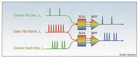
Bild 6 Optischer Schalter mit Vierwellenmischung
