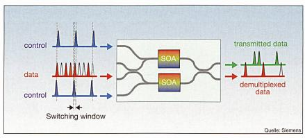
Bild 7 Funktionsweise eines optischen Schalters
