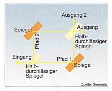
Bild 8 Mach-Zehner-Interferometer
