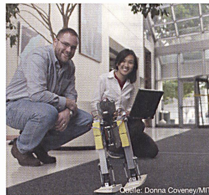
Quelle: Donna Coveney/MIT Der Roboter «Toddler» vom Massachusetts Institute of Technology (MIT) geht wie ein Mensch – vorgegeben durch das mechanische Design – und braucht darum nur wenig Energie.
