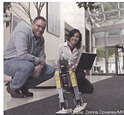
Der Roboter «Toddler» vom Massachusetts Institute of Technology (MIT) geht wie ein Mensch – vorgegeben durch das mechanische Design – und braucht darum nur wenig Energie.
