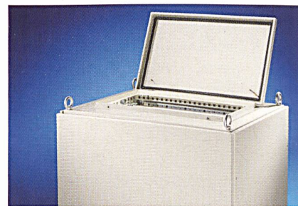
Die integrierten Druckentlastungskappen im Dach der TS8-Schränke von Rittal bewirken durch ihr selbsttätiges Öffnen das Abführen von Überdruck.
