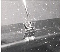
Wenn der Kontakt bei einem Verbindungselement schlecht ist, schmilzt das Material bei einem Blitzschlag weg. Nach der neuen Norm dürfen nur geprüfte Elemente verwendet werden.
