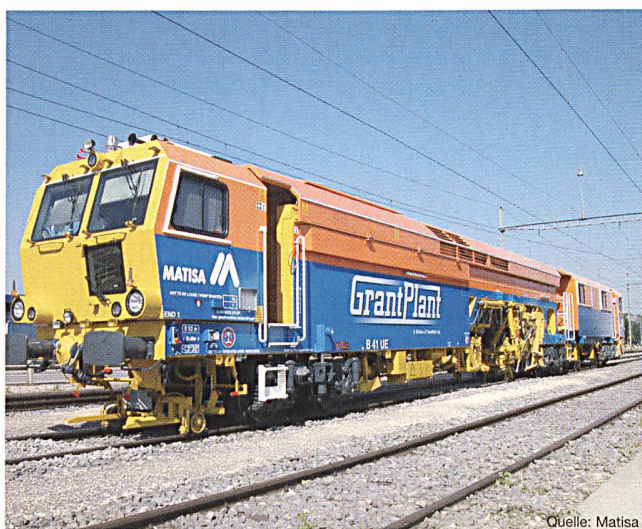
Bild 1 Gleisbaumaschinen richten die Schienen aus – mit Hilfe von Ethernet, um die Positionsdaten zu übertragen.
