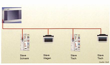
Bild 5 Feldbus der Polspulen-Lötmaschine
