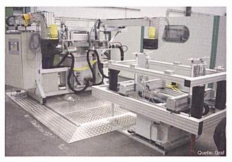
Bild 4 Polspulen-Lötmaschine
