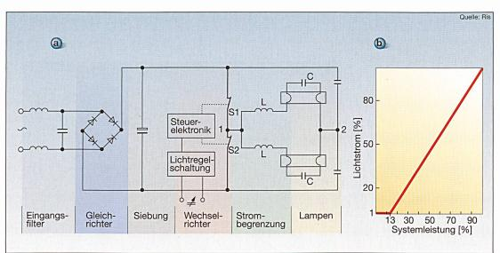
Bild 3 Elektronisches Vorschaltgerät EVG
