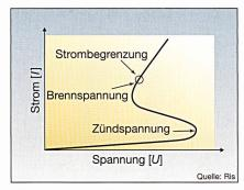
Bild 2 Kennlinie von Gasentladungslampen
