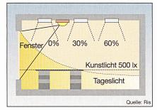
Bild 7 Einzelraumregelung. Erfasst wird die Leuchtdichte des Fensters
