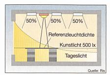
Bild 4 Einzelraumregelung mit Lichtsensoren
