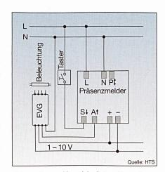
Bild 6 Präsenzmelder: minimale Stand-by-Verluste durch Relais und 1...10-V-Schnittstelle
