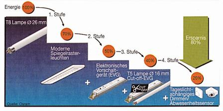
Bild 1 Energieeinsparmöglichkeiten beim Licht
