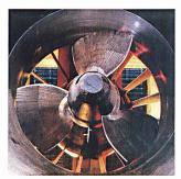
Rohrturbine (Bild VA Tech)
