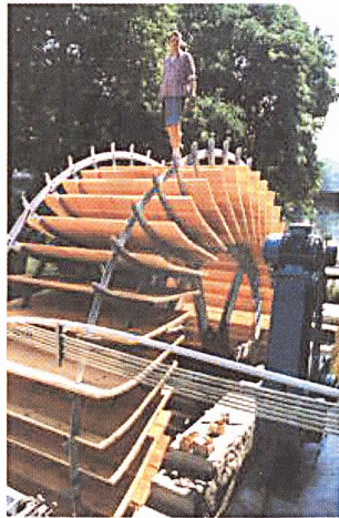
Mittelschlächtiges Wasserrad Zuppinger Bauart für grosses Schluckvermögen, niedriges Gefälle und starken Wasserstandsschwankungen (Bild HydroWatt).
