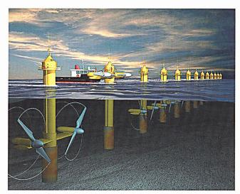
Mehrere «Seaflow»-Anlagen könnten einmal einen solchen Kraftwerkspark unter Wasser bilden (Bild Marine Current Turbines).
