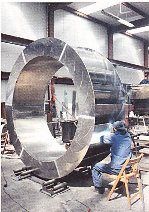
Das TURAS-Wasserrad mit integriertem Radnaben-Planetenge triebe wird komplett im Betrieb vorgefertigt (Bild Bega).
