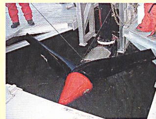
Axiale 16-kW-Versuchsturbine (Bild Verdant Power).
