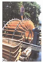
Mittelschlächtiges Wasserrad Zuppinger Bauart für grosses Schluckvermögen, niedriges Gefälle und starken Wasserstandsschwankungen (Bild HydroWatt).
