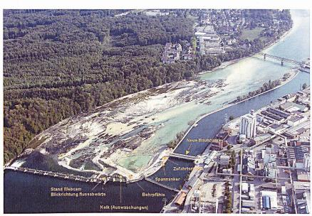
Neubauprojekt Wasserkraftwerk Rheinfelden: Luftaufnahme der Baustelle im Zuge der Bauarbeiten für die erste Etappe, das neue Stauwehr, das bis Mitte 2007 fertig gestellt sein soll. Rechts vom Wald die besondere Felsformation, das so genannte «Gwild», das weitgehend erhalten bleibt. Es wird so gestaltet, dass es die biologische Funktion des heutigen Gwilds weiter übernehmen kann (Foto: NaturEnergie AG).
