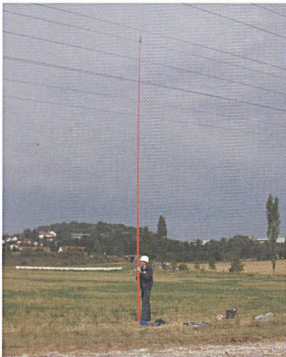
Modularer Spannungsprüfer von Dehn+Söhne
