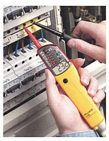
Spannungsprüfer der Serie T100 von Fluke mit integrierter Messtellenbeleuchtung
