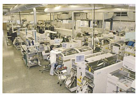
Bild 3 Die EMS-Fertigung ist aus der Leiterplattenbestückung entstanden, heute bieten die Firmen auch Entwicklung und Reparaturen an
