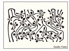
Bild 5 Pneumatische Leiterplatte
