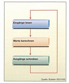
Bild 6 Ablauf der Steuerungssoftware
