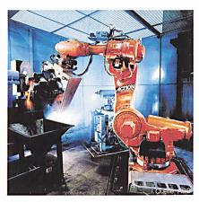
Bild 8 Knickarmroboter
