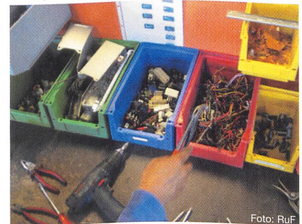
Das Entsorgen von Computern beginnt mit viel Handarbeit: Kondensatoren, Batterien und andere Schadstoffe werden entfernt (oben) ... und sortiert (unten). Das Ganze geht nach getaner Arbeit zurück zu Maag Recycling.
