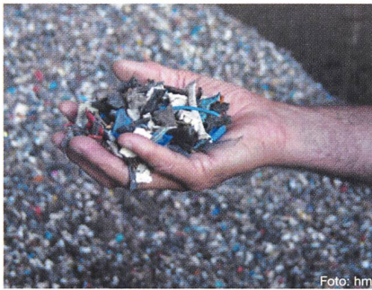
Dieses von Metallen befreite Granulat aus der Unterhaltungselektronik wird in einer Kehrichtverbrennungsanlage entsorgt.
