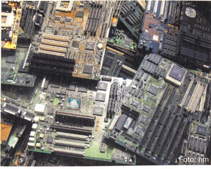
Aussortierte, von schädlichen Bestandteilen befreite Leiterplatten, bereit für die Wiederaufbereitung in eine Edelmetallscheideanstalt. Die Firma Maag Recycling erhält pro kg Leiterplatten etwa 3 Fr. für die daraus zurückgewonnenen Metalle.
