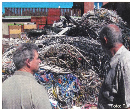
Berge von Elektrokabeln erheben sich temporär bei der Maag Recycling. Die täglich anfallende Menge von 2 Tonnen reicht aber noch lange nicht, um wirtschaftliches Recycling im Hause betreiben zu können. Dazu wären täglich 40 bis 50 Tonnen nötig.
