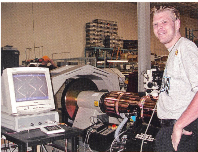
Links: Headtunen. Nach der Gravur misst das Messmikroskop über dem Zylinder die Nöpfchen und überträgt sie auf den Bildschirm, wo Remo Günter sie ausmisst und miteinander vergleicht. Ist das Ergebnis nicht befriedigend, muss er den Gravierkopf neu ausrichten. – Rechts: Das Team Engineering Electrical/Electrical/Technical-Workshop, mit welchem Remo Günter in Dayton zusammenarbeitet.
