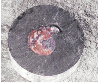
Bohrkern mit Opalinuston.
