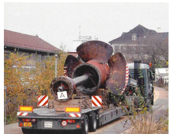
Neue Kaplan turbine für das Wasserkraftwerk Letten in Zürich.
