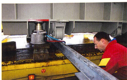
Die Führungsrollen müssen genau auf die Schienen passen (Bilder: zconsulting).
