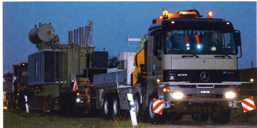
Im Morgengrauen des 13. Oktobers liessen die EKZ den 65 t schweren Unterwerktrafo (40 MVA) auf einem 6-Achser-Tiefgänger und Zug- und Stossfahrzeug vom EKZ Service Center in Dietikon nach Obfelden transportierten (Bild: ekz).
