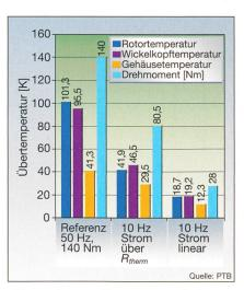
Bild 10 Bessere Maschinenausnutzung durch Optimierung des Schutzkonzeptes
