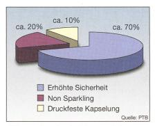
Bild 1 Verteilung der Zündschutzarten bei Motoren in der chemischen Industrie Deutschlands (Schätzung)
