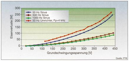
Bild 7 Oberschwingungseisenverluste bei einer Maschine der Baugrösse 132
