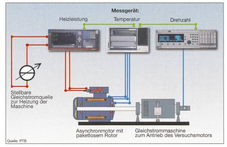
Bild 4 Versuchsaufbau zur Bestimmung des Wärmeübergangswiderstandes
