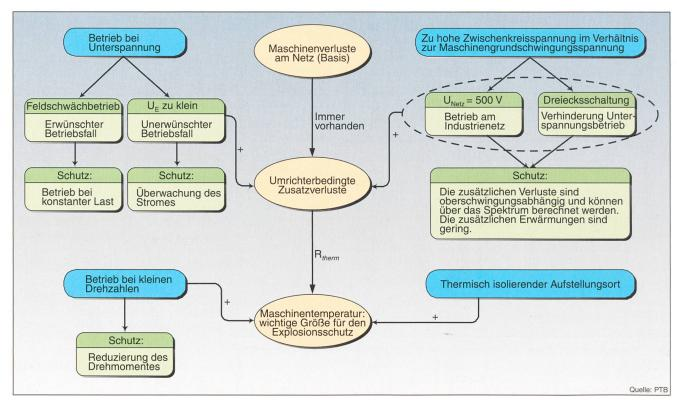
Bild 9 Sicherstellung des Explosionsschutzes bei umrichtergespeisten Antrieben
