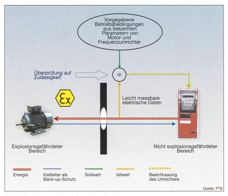
Bild 11 Flussdiagramm eines optimierten Motorschutzkonzeptes
