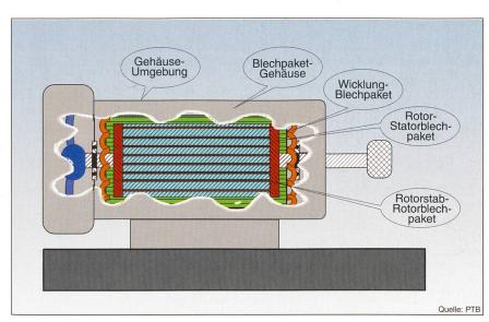
Bild 5 Innere Wärmeübergangswiderstände einer Asynchronmaschine
