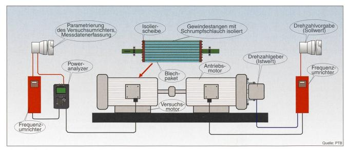
Bild 6 Versuchsaufbau zur Bestimmung der Eisenverluste
