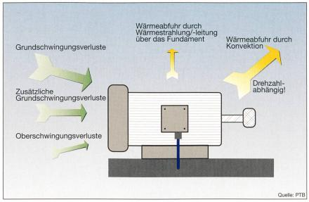
Bild 2 Thermisches Gleichgewicht an einer Induktionsmaschine
