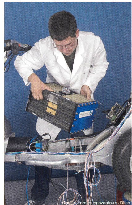
Der Brennstoffzellen-Stapel besteht aus 100 einzelnen Zellen
