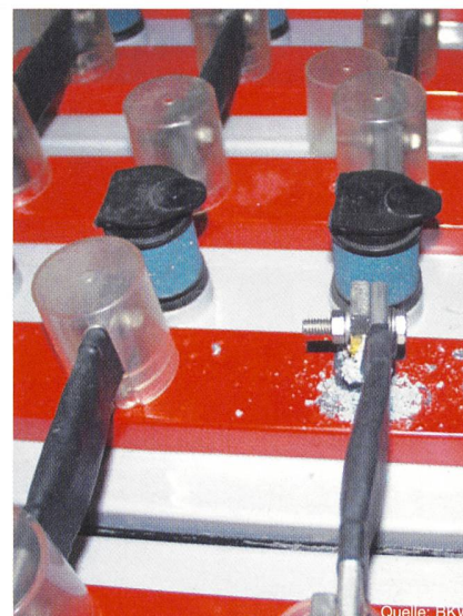
Bild 3 Korrosion an den Anschlüssen
