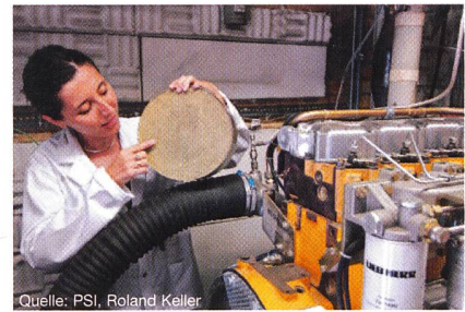
Die Chemiedoktorandin Gaia Piazzesi zeigt den wabenförmigen SCR-Katalysator, der mehr als 90 Prozent der Stickoxide im Abgasstrom entfernt. Rechts der Dieselmotor des Teststands.
