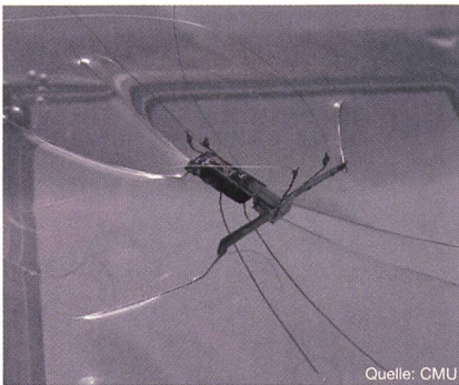
Der kleine Roboter steht wie ein Insekt auf dem Wasser – dank dessen Oberflächenspannung
