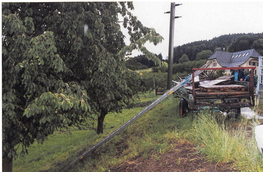
Beim Aufstellen der Leiter berührte eine Frau den unteren Draht einer 16-kV-Freileitung. En dressant l'échelle, une femme a touché le fil inférieur d'une ligne aérienne 16 kV.
