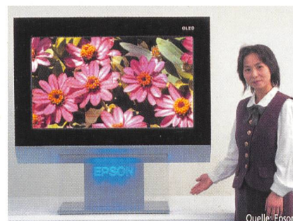
Prototyp eines 40-Zoll-OLED-Bildschirms mit 1280 x 768 Pixeln (WXGA) und 260 000 darstellbaren Farben. 2007 soll das Produkt erhältlich sein.
