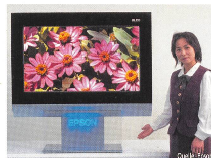
Prototyp eines 40-Zoll-OLED-Bildschirms mit 1280 x 768 Pixeln (WXGA) und 260 000 darstellbaren Farben. 2007 soll das Produkt erhältlich sein.
